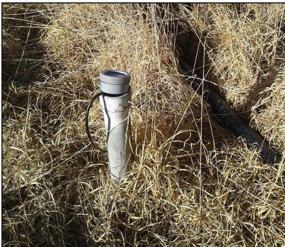
Figure 20 : Piézomètre implanté sur la zone d'étude et sonde piézométrique
