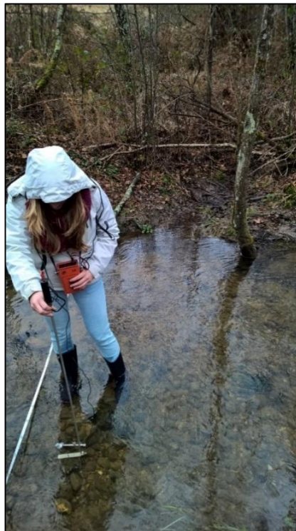
Figure 34 : Mesure du débit par la technique du jaugeage par moulinet (source : personnelle).
