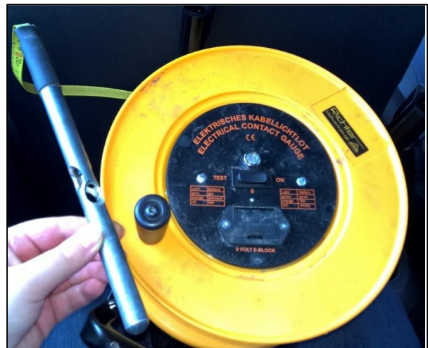
Figure 20 : Piézomètre implanté sur la zone d'étude et sonde piézométrique
