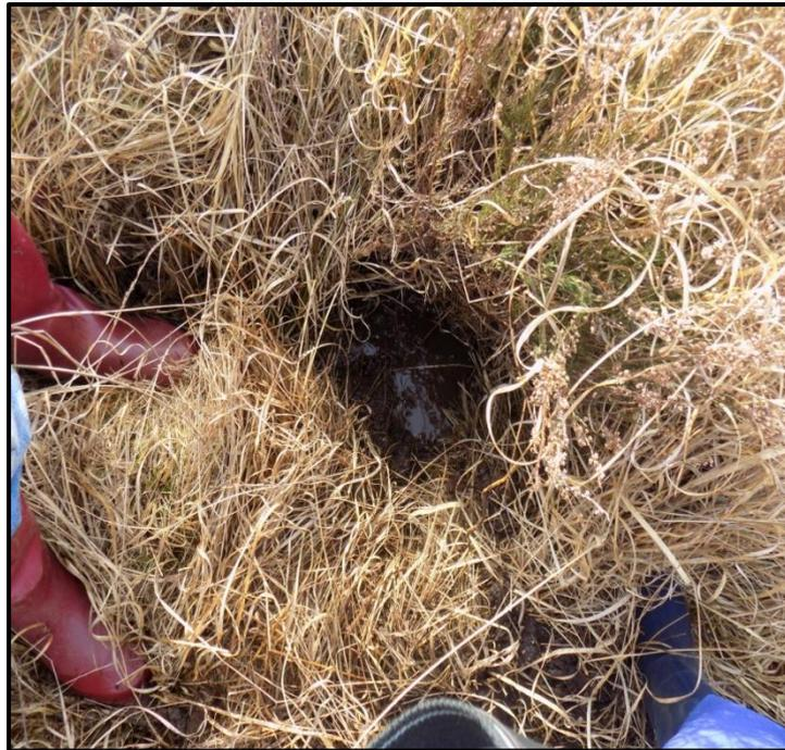
Figure 56 : Photographie d'un trou réalisé à la tarière qui s'est immédiatement colmaté
