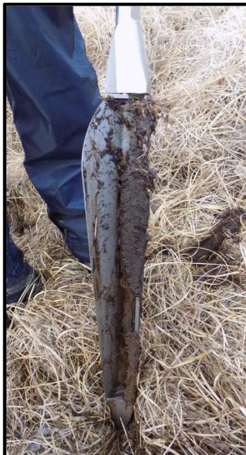
Figure 44 : Prélèvement d'une tranche de sol à l'aide d'un carottier Russe
