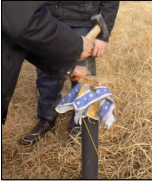
Figure 39 : Implantation d'un piézomètre
