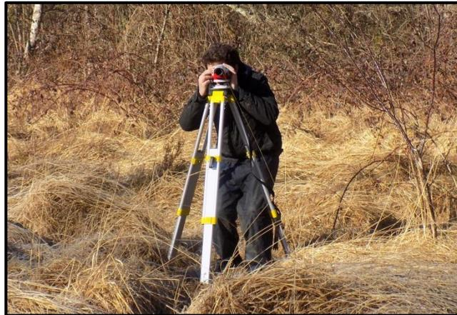
Figure 41 : Réalisation du nivellement des piézomètres
