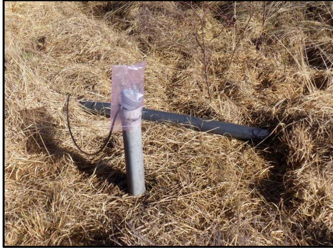
Figure 43 : Sonde mini Orpheus installée dans le piézomètre 22
