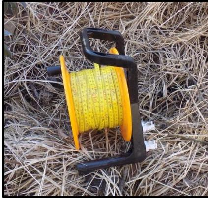
Figure 35 : Sonde piézométrique
