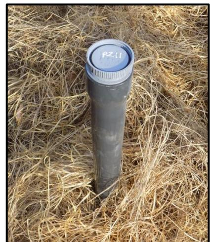
Figure 34 : Piézomètre implanté sur le site
