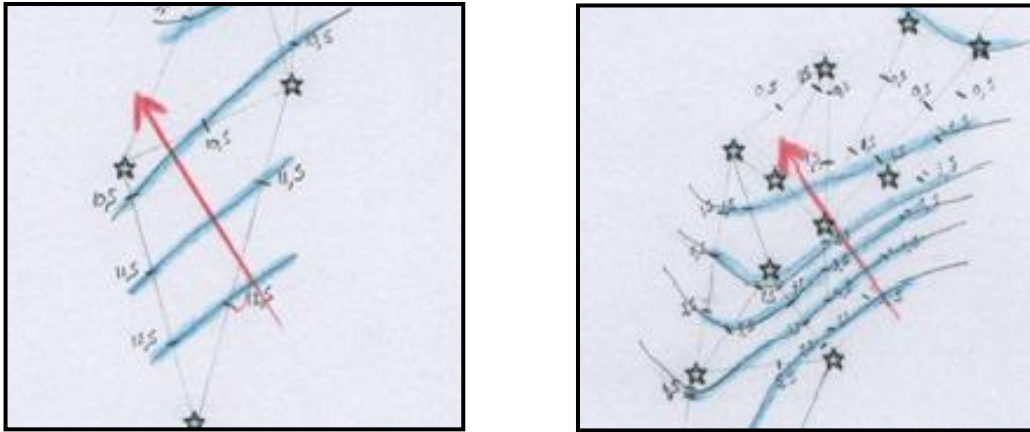
Figure 50 : Détails de la carte piézométrique avec les points utilisés pour calculer le gradient hydraulique au Sud (gauche) et au Nord (droite)
